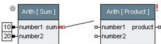
2. Ziehen Sie nun mit gedrückter Maustaste ein Verbindung zum Eingangspin *"number1"* am Schritt *"Arith [ Product ]"* und lösen sie die Maustaste über dem Eingangspin .
